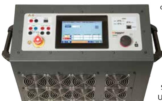
Test se može vršiti konstantnom strujom, konstantnom snagom, konstantnom otpornošću, ili saglasno unapred odabranom profilu opterećenja.
