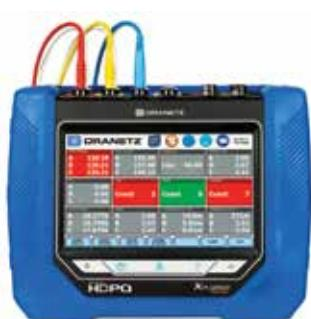
Dranetz HDPQ Guide je srednji model, uključuje sve osobine koje ima Dranetz HDPQ Visa, ali dodaje Wi-Fi komunikaciju, mogućnost ugradnje Answer modula, i bafer od 10,000 snimljenih ciklusa koristan za snimanje kvarova i primenu prilikom puštanja opreme u rad.
