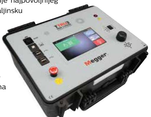
Opciono se može poručiti: štampač za trenutno štampanje na terenu, merenje magnetnog balansa, automatski rad preko softvera PowerDB, kao i merenje na trafoima sa nestandardnim faznim pomerajem.
